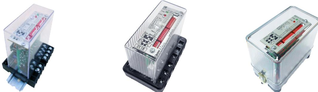
Реле частоты статические серии РСГм-11 предназначены для использования в схемах релейной защиты и противоаварийной автоматики в цепях переменного тока частоты 50 Гц в качестве органов, реагирующих на повышение или понижение частоты.
